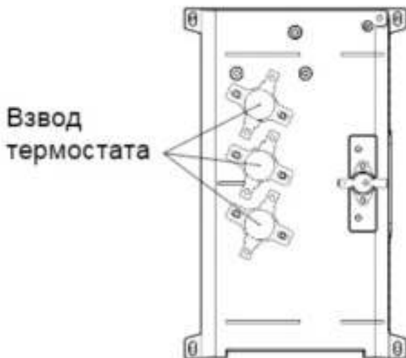
Рис. 22. Ручное восстановление термостатов
