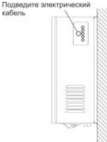
Рис. 10. Расположение панели вывода электрического кабеля
