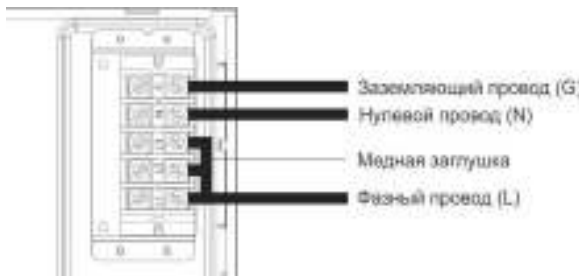
Рис 11. Однофазное подключение прибора
